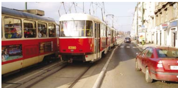
Rašínovo Nábřeží. Wydzielenie torowiska separatorem - tani i skuteczny sposób na usprawnienie komunikacji (AB)
