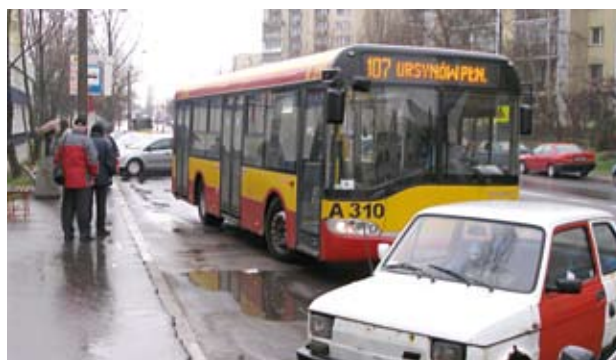
Zatoki autobusowe bywają lokowane w miejscach, gdzie nie są wcale potrzebne. Skutkuje to znacznym zwężeniem przystanku oraz wydłużeniem czasu jazdy autobusu - tutaj musi manewrować między zaparkowanymi w zatoce samochodami. (RM)
